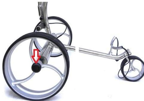
2. Verbinden Sie den Vorderbau mit dem Hinterbau indem Sie den Sicherungspin gedrückt halten bis dieser im Rahmen verschwindet und in der dafür vorgesehenen Bohrung einrastet. Verbinden Sie das Lenkgestänge mittels der Schnellspannschraube am Hinterbau. **Wichtig:** Der Anschluss für das Systemkabel (6-polig) muss hierbei auf der (in Fahrtrichtung) linken Seite sein.
