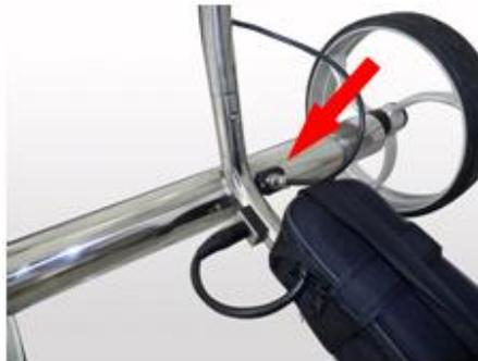
6. Montieren Sie Akkuhalterung am Vorderradgestänge mit den beiliegenden Halbschellen. Stellen Sie den geladenen Akku auf die Halterung und sichern ihn mit den beiliegenden Klettgurten gegen seitliches Herunterrutschen. Anschließend verbinden Sie das Akkukabel mit der Anschlußbuchse (3-polig). Diese befindet sich in Fahrtrichtung rechts. Eine Verlängerungskabel zum Versteuern des Akkus im Bag ist optional erhältlich.
